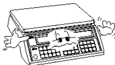
Unikać ustawiania wagi w pobliżu silnego pola elektromagnetycznego
